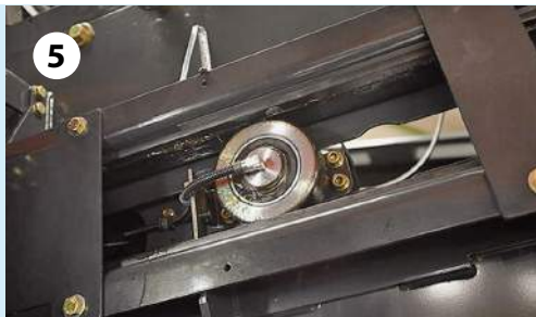
Wydajny tłok: 46 uderzeń na minutę, prowadzony na rolkach o średnicy 12,5 cm
