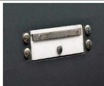
Czujnik wilgotności zintegrowany z elektroniką ISO
