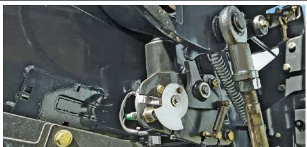
Elektryczna regulacja długości beli
