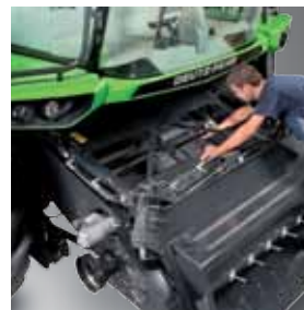
Zdejmowane osłony przęnośnika pochylego, wygodna kontrola przęnośnika łańcuchowo-listwowego.
