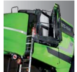
Chłodnice otwierane na bok ułatwiają czyszczenie.
