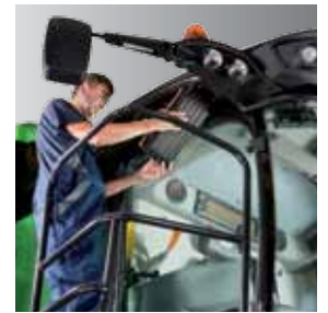
Filtry kabinowe umieszczone w dobrze dostępnym miejscu.
