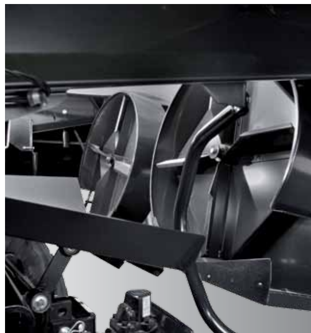
Sieczkarnia z nowymi kierownicami wyposażona w bęben ze wzmocnionymi nożami.
