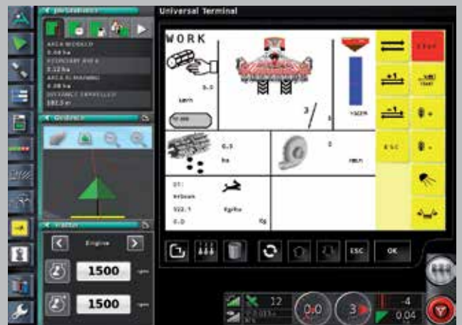
Funkcja TIM (Tractors Implement Management) odpowiedzialna za sterowanie ciągnika na bazie sygnału z maszyny.
