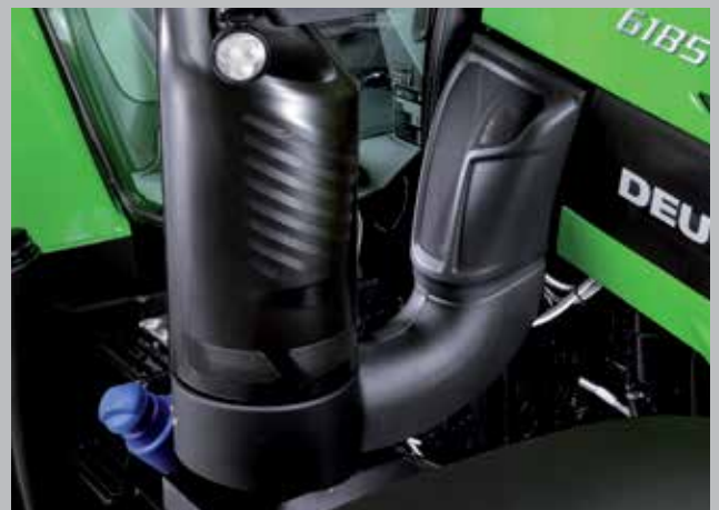
Układ oczyszczania spalin SCR oraz DPF (filtr cząstek stałych) z pasywną regeneracją zapewnia oszczędność paliwa i zmniejszenie kosztów eksploatacji.
