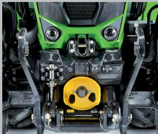
Nowy przedni podnośnik z funkcją sterowania położeniem ma większy udźwieg (tylko modele TTV).
