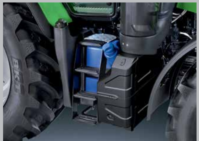
Mniejsze zużycie paliwa i AdBlue. 280-litrowy zbiornik paliwa i 35-litrowy zbiornik AdBlue umożliwiają dłuższą pracę bez tankowania.
