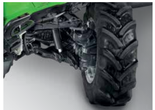
Niezależna amortyzacja kół przedniej osi.
