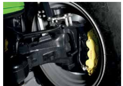
60 km/h przy 1785 obr./min z zachowaniem pełnego bezpieczeństwa dzięki hamulcom tarczowym z ABS.
