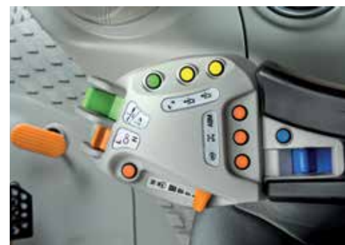
Podłokietnik w modelach Standard z nowym, zintegrowanym przełącznikiem przedniego podnośnika.
