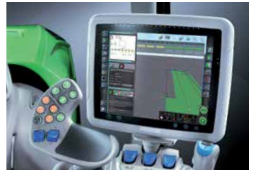
Nowoczesne centrum sterowania funkcjami ciągnika czyli iMonitor drugiej generacji z ekranem dotykowym.
