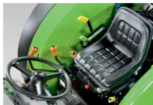
Przestronne, komfortowe stanowisko operatora, dźwignie sterowania po prawej stronie fotela operatora.
