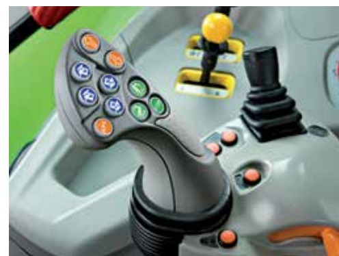
Napęd zrobotyzowany w modelach Cshift. Zmiana biegów i półbiegów przy użyciu joysticka.
