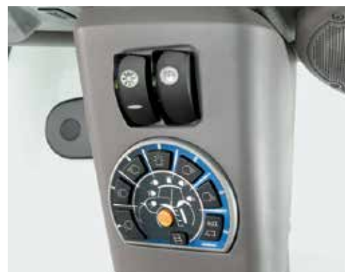
Panel sterowania oświetleniem daje pełną kontrolę nad reflektorami zamontowanymi na ciągniku.
