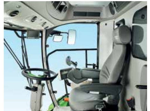
Ergonomiczna i komfortowa kabina. Regulowana kolumna kierownicy, intuicyjne sterowanie.
