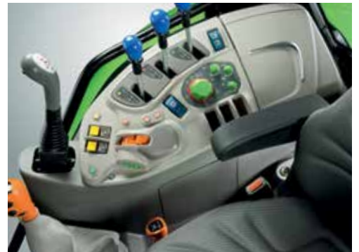
Prawa konsola ze zintegrowanym joystickiem do sterowania ładowaczem czołowym.
