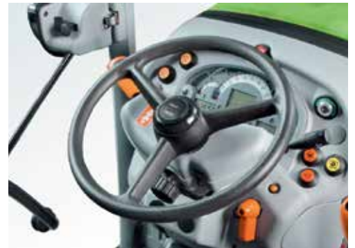
Panel wskaźników modeli Agroplus S/V obejmuje wskaźniki analogowe i wyświetlacz cyfrowy. Operator otrzymuje czytelne, dokładne parametry eksploatacyjne ciągnika.
