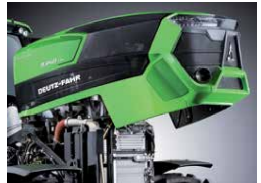
Elektrycznie, wysoko unoszona maska silnika ułatwia wykonywanie podstawowych czynności obsługowych.
