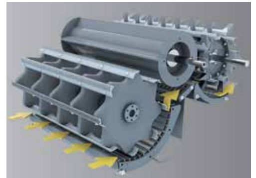
System omlotu Maxi-Crop: bęben o średnicy 600 mm i szerokości 1,27 metra w modelach 5 klawiszowych i 1,52 metra w sześcioklawiszowych, 8 cepów zapewnia optymalny omlot.
