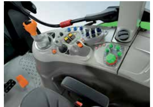
Przyrządy sterownicze pogrupowane kolorystycznie i ułożone na prawej konsoli w kabinie ciągnika.
