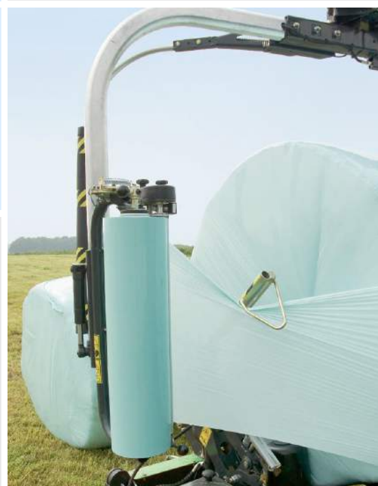
„Nożycowa” konstrukcja obcinacza gwarantuje czyste i równe obcięcie folii.
