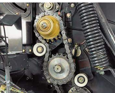
Drugi wałek napędowy zapewniający obracanie beli nawet w przypadku trudnych do prasowania materiałów, seryjnie montowany w modelach VARIMASTER BALEPACK, opcjonalnie w VARIMASTER.
