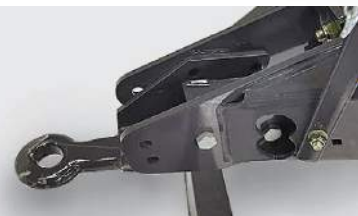
Odwracalny zaczep ułatwiający podłączenie maszyny do górnego lub dolnego zaczepu ciągnika.
