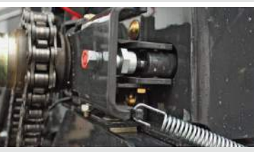
Hydrauliczne sprzęgło rotora sterowane z kabiny ciągnika.
