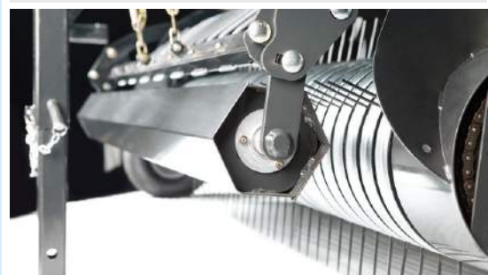
Rolka podbieracza zapewniająca równomierny przepływ materiału
