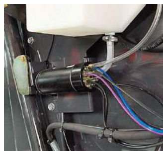
Automatyczny system smarowania łańcuchów (opcja) pozwalający indywidualnie dostosowywać ilość oleju dla każdego łańcucha.
