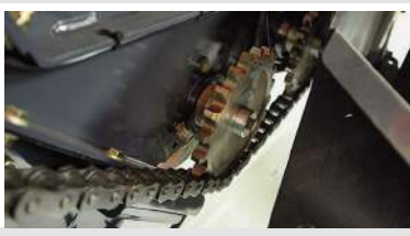
Prosty układ napędowy z mocnymi łańcuchami 1¼", o ograniczonych wymaganiach serwisowych nawet w najtrudniejszych warunkach.
