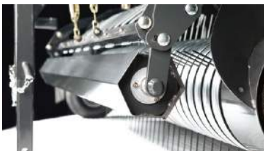
Opcjonalna rolka osłony podbieracza zapewniająca równomierne podawanie materiału.
