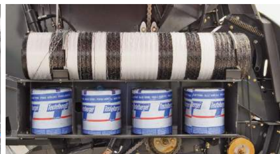
System owijania siatki i/lub sznurkiem zapewniający dużą elastyczność pracy.
