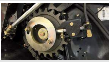
Automatyczny system smarowania pozwala indywidualnie dostosowywać ilość oleju dla każdego łańcucha.
