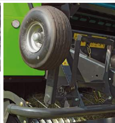
Koła kopiujące podbieracza w pozycji transportowej.
