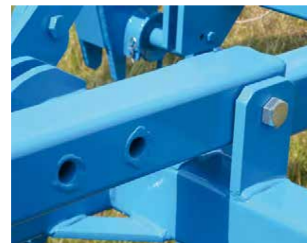
regulacja odległości wału za maszyną
