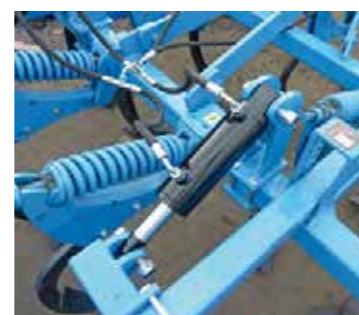
hydrauliczna regulacja głębokości pracy
