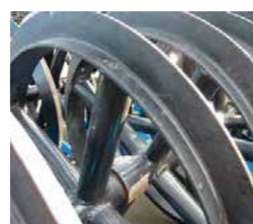
wał T-ring \varnothing 600 mm
