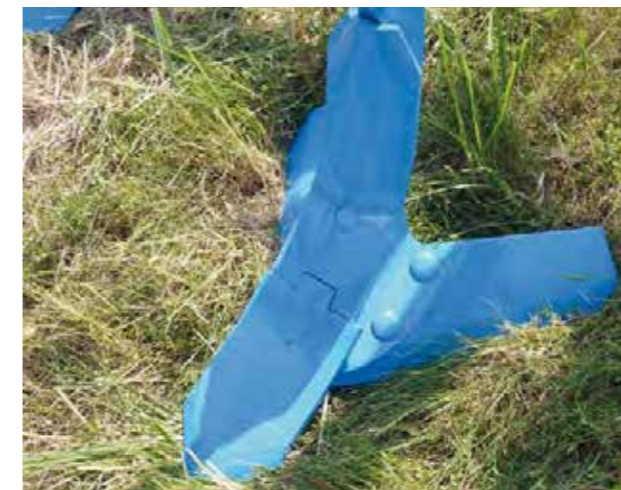
pięcioelementowy system podcinający (szer. podcinania 530 mm)
