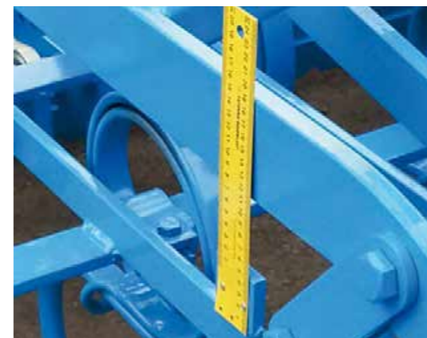
miara wyznaczająca głębokość pracy
