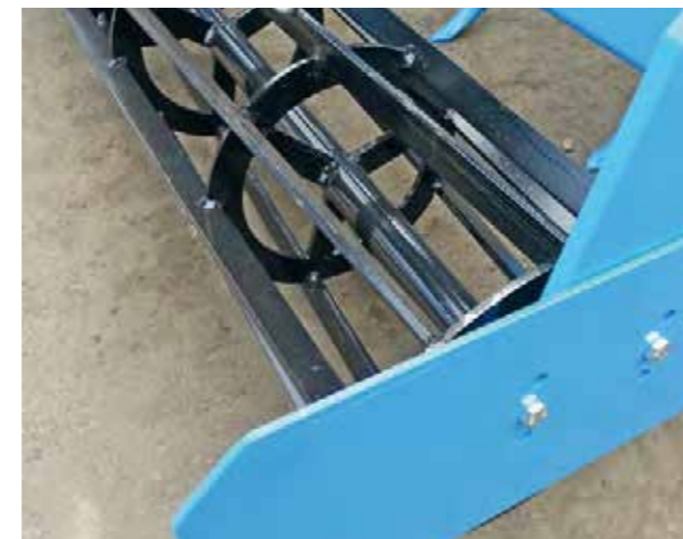
wzmocnione wały płaskownikowe \varnothing 350 mm
