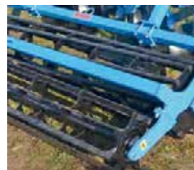
wał Tandem (rurowy Ø 540 mm + płaskownikowy Ø 400 mm)
