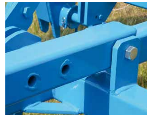
regulacja odległości wału za maszyną
