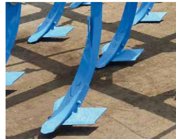
elementy podcinające z wysoką odkładnicą (szer. podcinania 310 mm)
