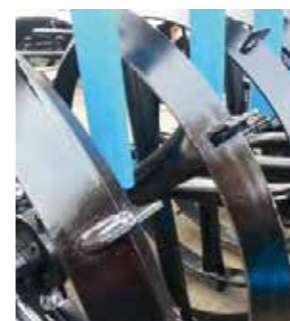
wał daszkowy \varnothing 600 mm z zabierakami
