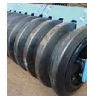
wał gumowy \varnothing 500 mm
