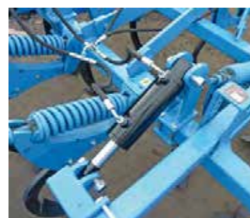
hydrauliczna regulacja głębokości pracy
