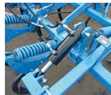
hydrauliczna regulacja głębokości pracy
