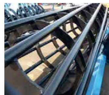
wał rurowy \varnothing 620 mm
