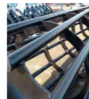
wał rurowy \varnothing 620 mm
