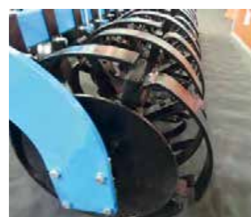
wał sprężynowy \varnothing 445 mm
