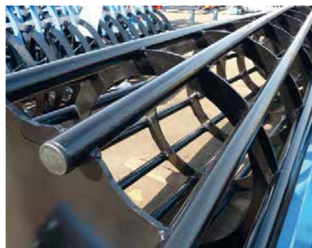
wał rurowy \varnothing 540mm
