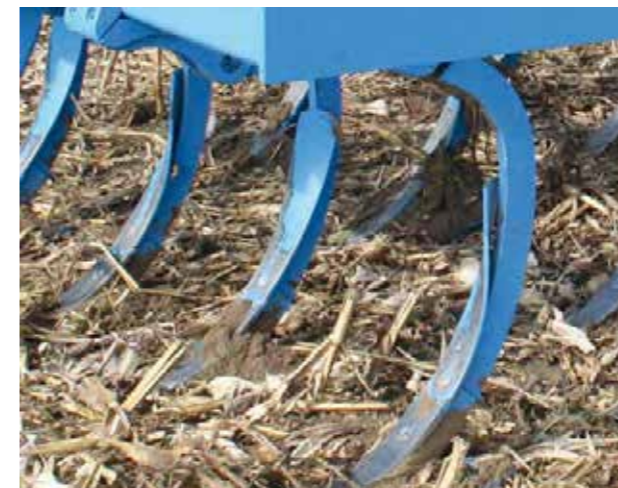
zab sierpowaty z wysoką odkładnicą (szer. podcinania 270 mm)
