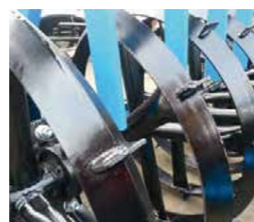
wał daszkowy \varnothing 600 mm z zabierakami
