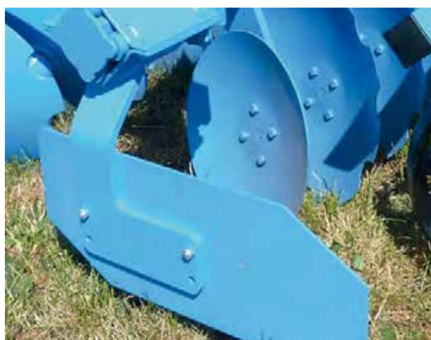
ekrany boczne zaczezione na gumach amortyzujących
