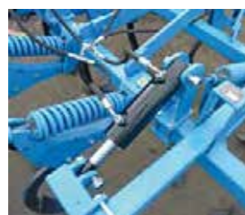
hydrauliczna regulacja głębokości pracy
