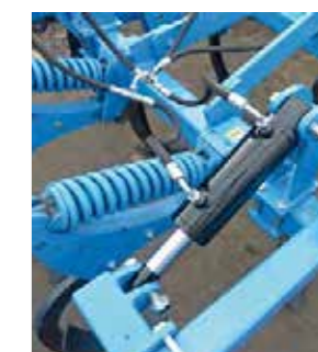
hydrauliczna regulacja głębokości pracy
