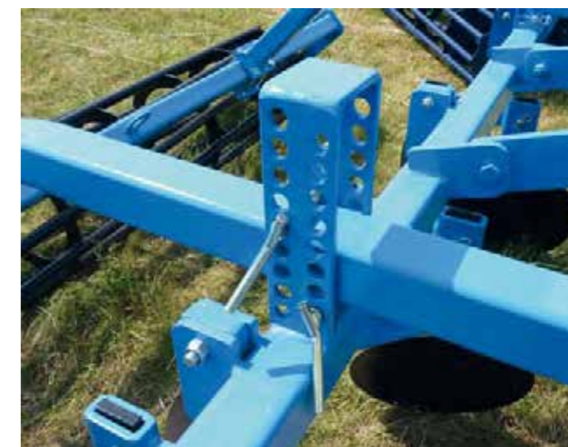
regulacja głębokości pracy na drabinkach
