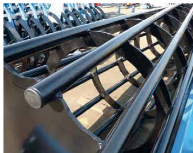
wał rurowy \varnothing 540mm
