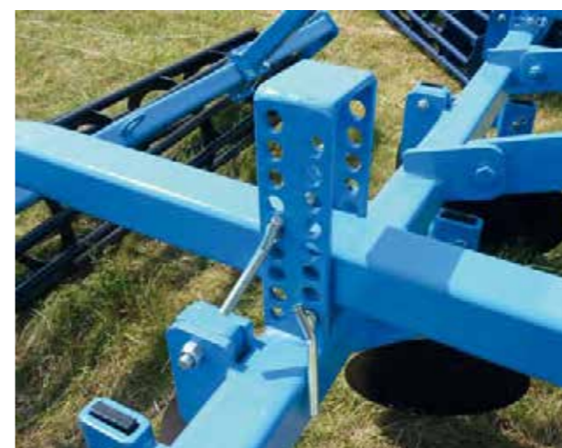
regulacja głębokości pracy na drabinkach
