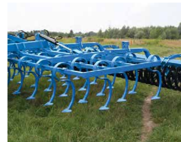
cztery rzędy zębów 70x12 zakończonych gęsią stopą
