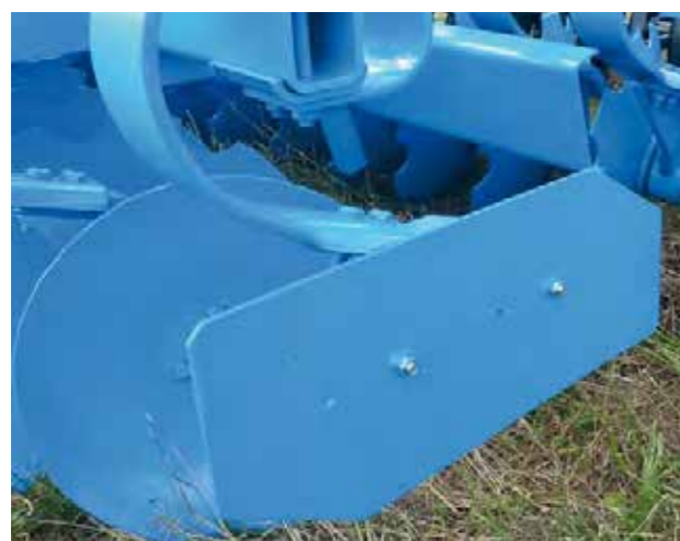
ekrany boczne zaczepione na sprężynie
