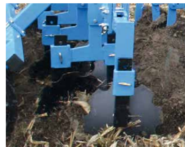
belka z talerzami zawieszona na ramionach wału
