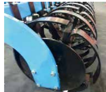
wał sprężynowy Ø 445 mm
