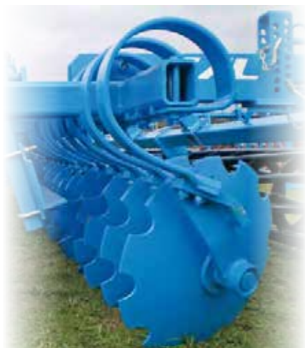
sprężyna amortyzująca 100x13 mm
