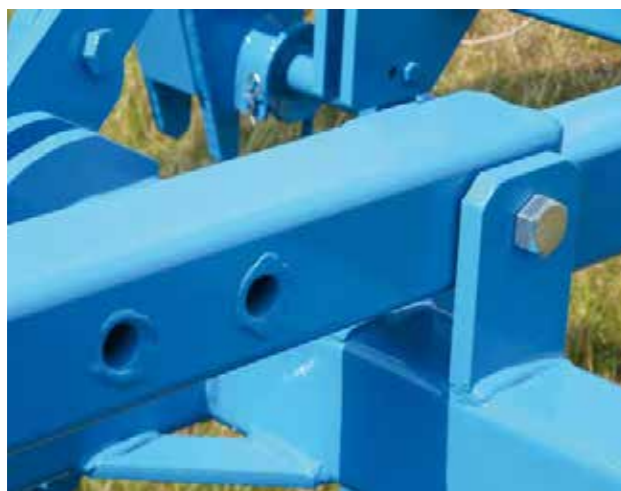
regulacja odległości wału za maszyną (za wyjątkiem GAL-K)
