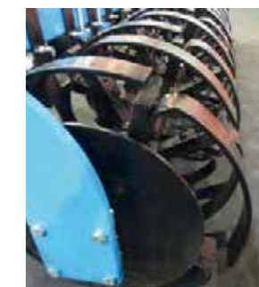
wał sprężynowy \varnothing 445 mm
