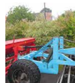
wózek transportowy ze sprzęgiem siewnika
