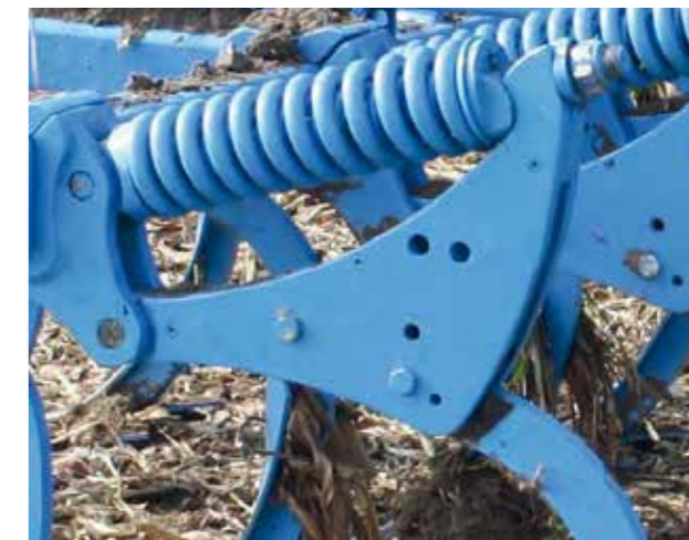
zabezpieczenie podwójne sprężynowe (TOP-S)
