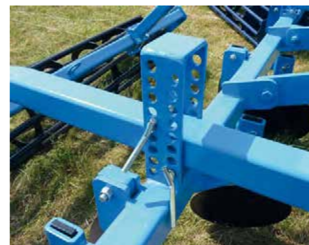
regulacja głębokości pracy na drabinkach
