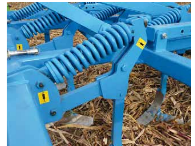
zabezpieczenie sprężynowe (KUS S)
