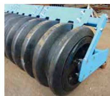
wał gumowy \varnothing 500 mm
