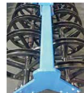
wał C-ring Tandem \varnothing 600 mm
