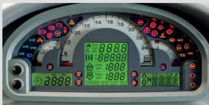
Zestaw wskaźników analogowo-cyfrowych. Deska rozdzielcza Serii 5D.
