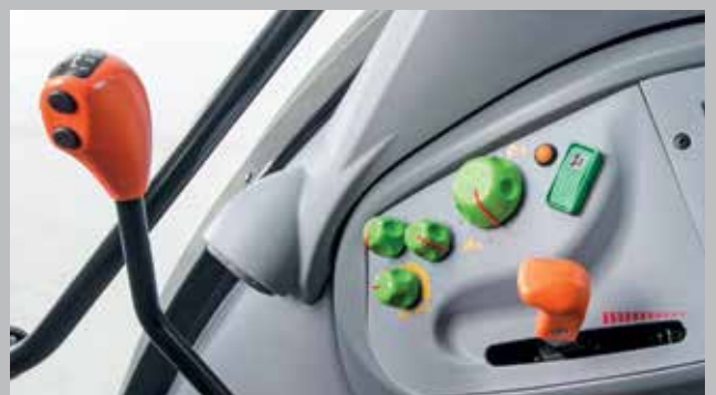
Dźwignia zmiany biegów w modelu ze skrzynią 45+45 z półbiegami Powershift.
