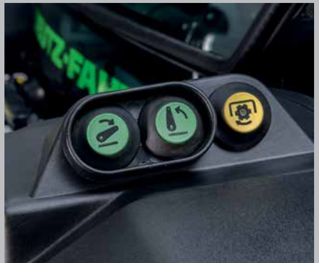
Sterowanie tylnego podnośnika i WOM na błotnikach kabiny ciągnika.
