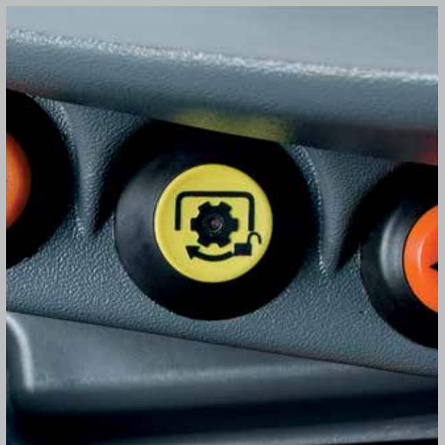
Elektro-hydrauliczne sterowanie WOM.
