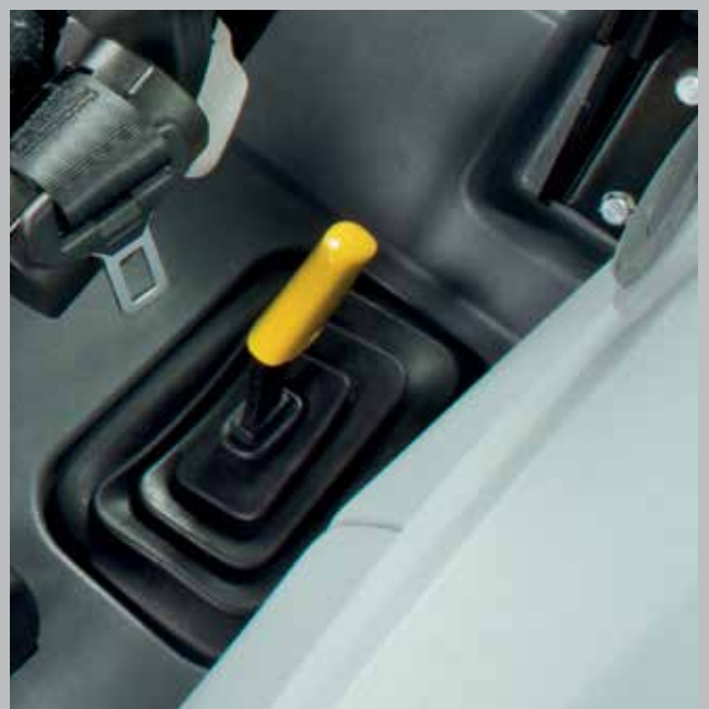
Mechaniczne sterowanie WOM w wersji Ecoline.
