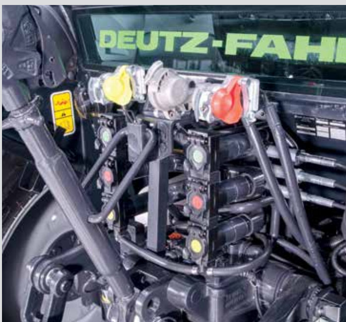
Maksymalnie trzy obwoły układu hydraulicznego.
