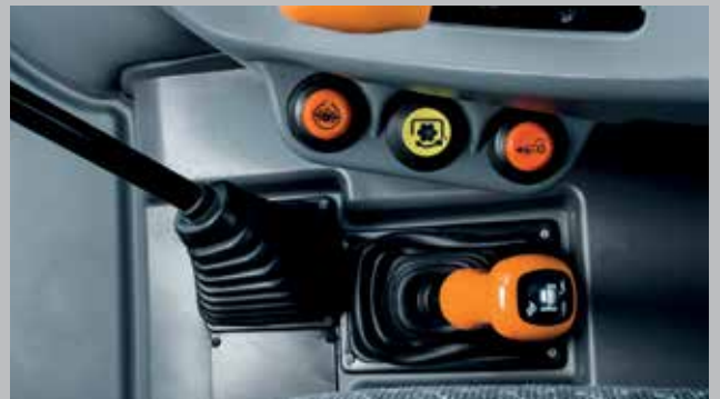
Elektrohydrauliczne sterowanie WOM, napędem na cztery koła i blokadą mechanizmów różnicowych (LS i GS).
