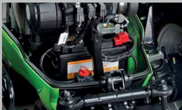
Główny wyłącznik prądu w przedniej części komory silnika.
