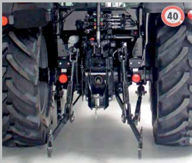
Mocny tylny podnośnik i gniazda hydrauliki zgrupowane z tyłu ciągnika.
