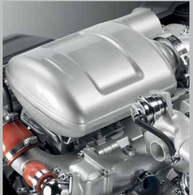
Katalizator DOC (Diesel Oxidation Catalyst) - brak czynności obsługowych, brak dodatkowych środków, płynów.
