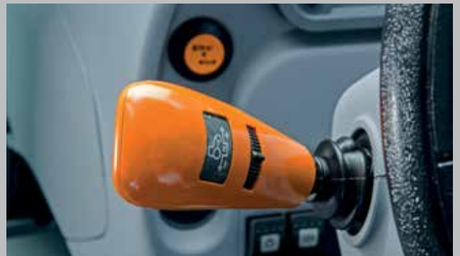
Dźwignia rewersu elektro-hydraulicznego Powershuttle z regulacją czułości i przycisk aktywacji funkcji Stop&Go.
