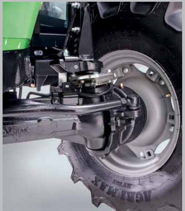
Hamulce na cztery koła z tarczami w kąpielii olejowej.
