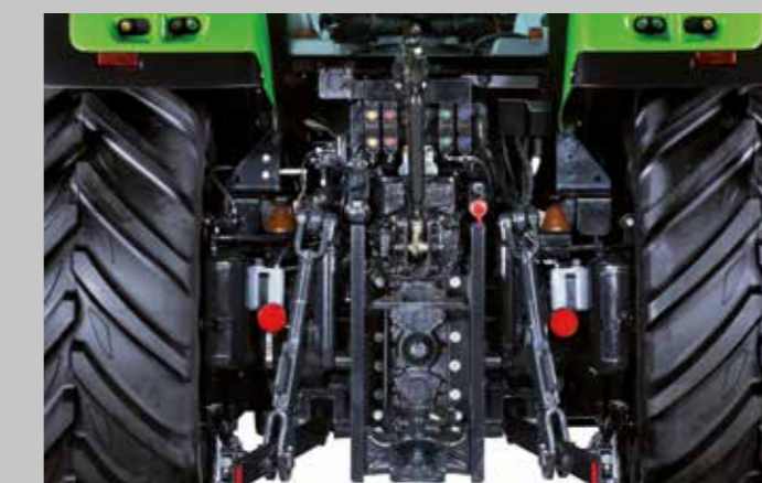
Imponujące parametry, podnośnik elektroniczny z udźwigniem 7000 kg, 3 prędkości wałka.
