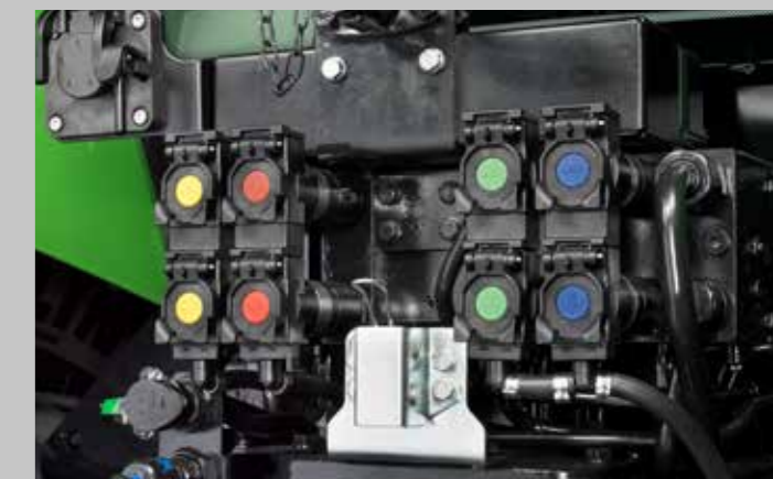
Współpraca z maszynami. Wyposażenie obejmuje maks. 4 obwody sterowane mechanicznie i pompę 90 l/min lub maks. 5 obwodów sterowanych elektronicznie i pompę 120 l/min.
