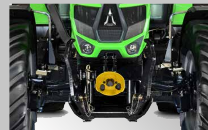
Mocny podnośnik przedni o udźwigniu do 2880 kg. Opcjonalny pakiet Comfort z jednym obwodem hydrauliki z przodu.
