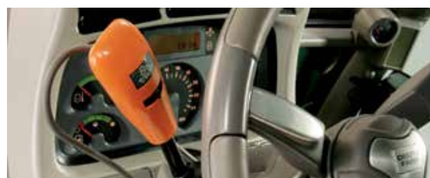
Rewers Powershuttle: 5 ustawień szybkości reakcji rewersu, wybieranych potencjometrem na dźwigni.
