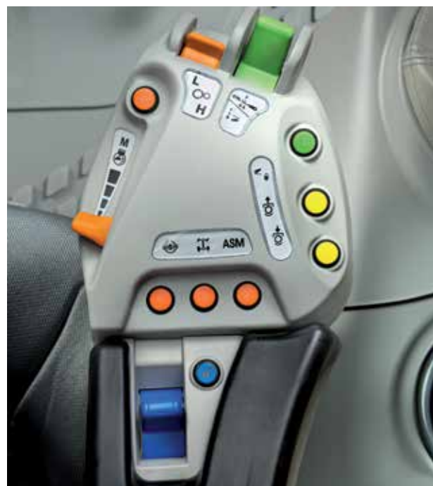
Podłokietnik modelu standard ze sterowaniem podstawowymi funkcjami i nowym przelącznikiem sterowania przednim podnośnikiem.
