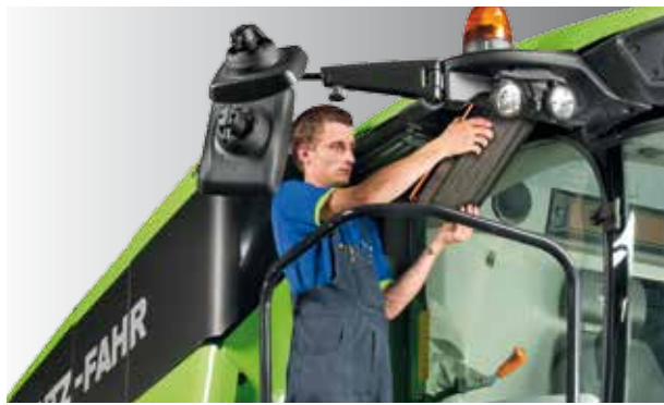
FILTRY KABINOWE. Łatwa wymiana filtrów bez użycia narzędzi.
