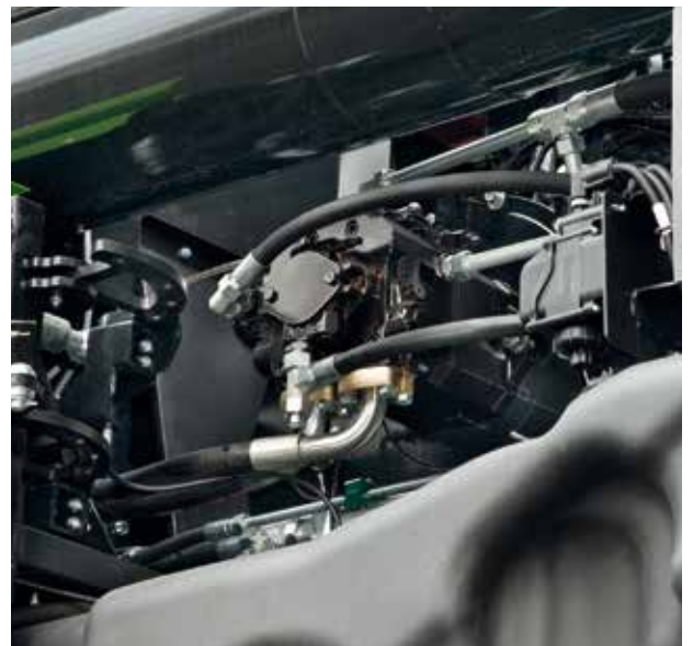
POMPA O ZMIENNEJ WYDAJNOŚCI. Pompa przymocowana bezpośrednio do wału silnika.
