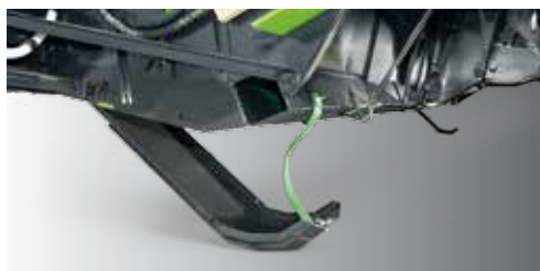
Płozy pod hederem zapewniają precyzyjne kopiowanie terenu po którym porusza się kombajn.
