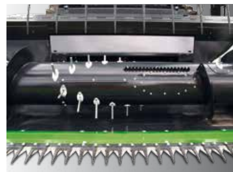
Przeñośnik ślimakowy z palcami na całej szerokości dla zapewnienia najlepszego przepływu masy.
