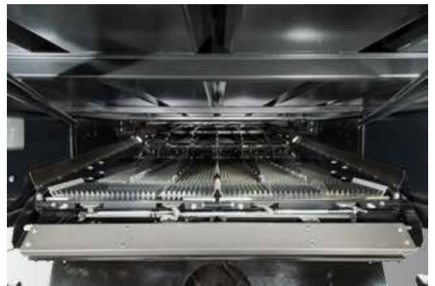
Opcjonalnie, kombajny C7000 wyposażone są w sterowany elektrycznie układ regulacji sit.
