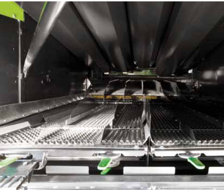
System czyszczenia najwyższej klasy - ze względu na powierzchnię, jak i na wydajność. Turbina i dwie minimłocarnie sprawiają, że kombajn z serii 6040 osiąga wydajność nieznaną do tej pory w tym segmencie kombajnów.
