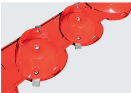
Gładka dolna strona belki z zaokrąglonymi płozami ślizgowymi.
